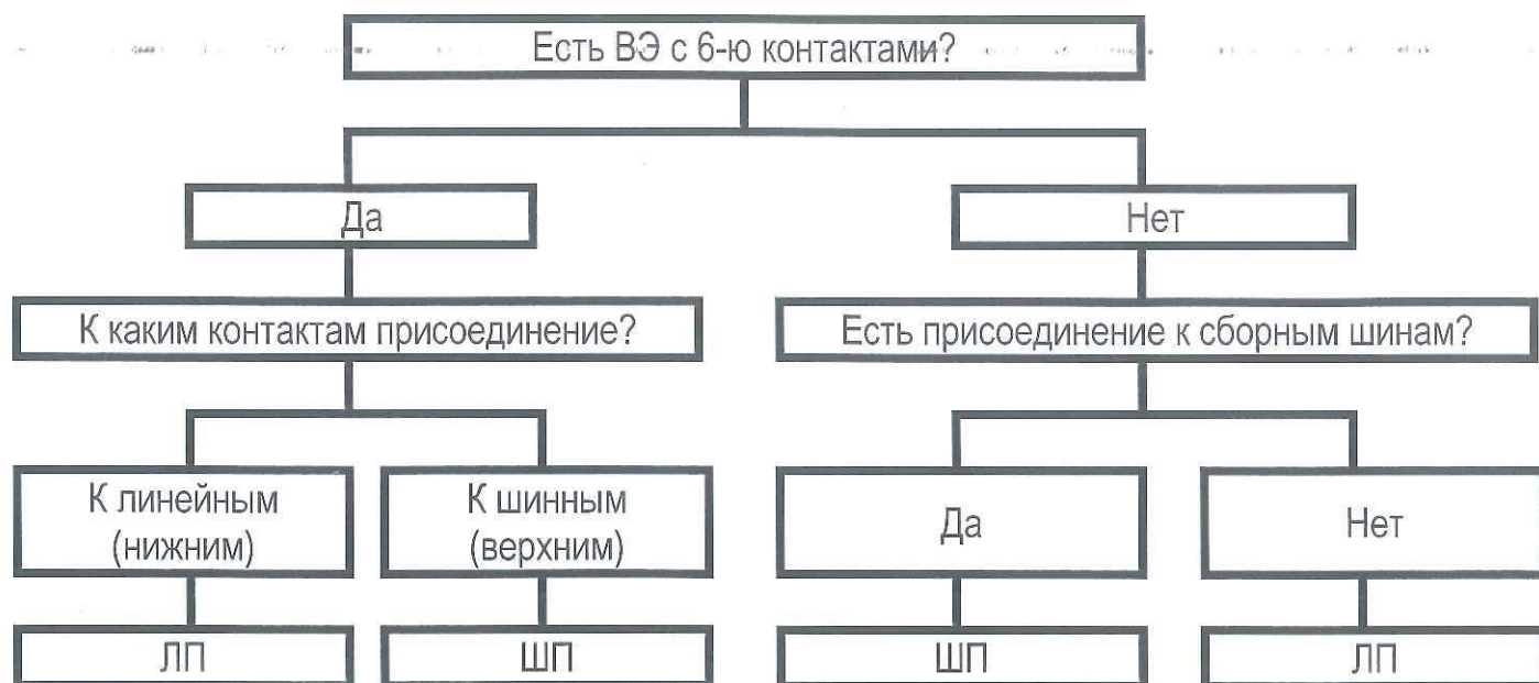
Рисунок 2 – Определение вида присоединения (в скобках указано для КРУ с верхним расположением сборных шин СЭЩ-80-10Н)
